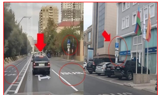
Xocalı prospekti (nişanlanma xətti çəkilib, lakin parklanma yerinə daxil olub və oranı tərk etmək üçün qırıq-qırıq xətt yoxdur)
